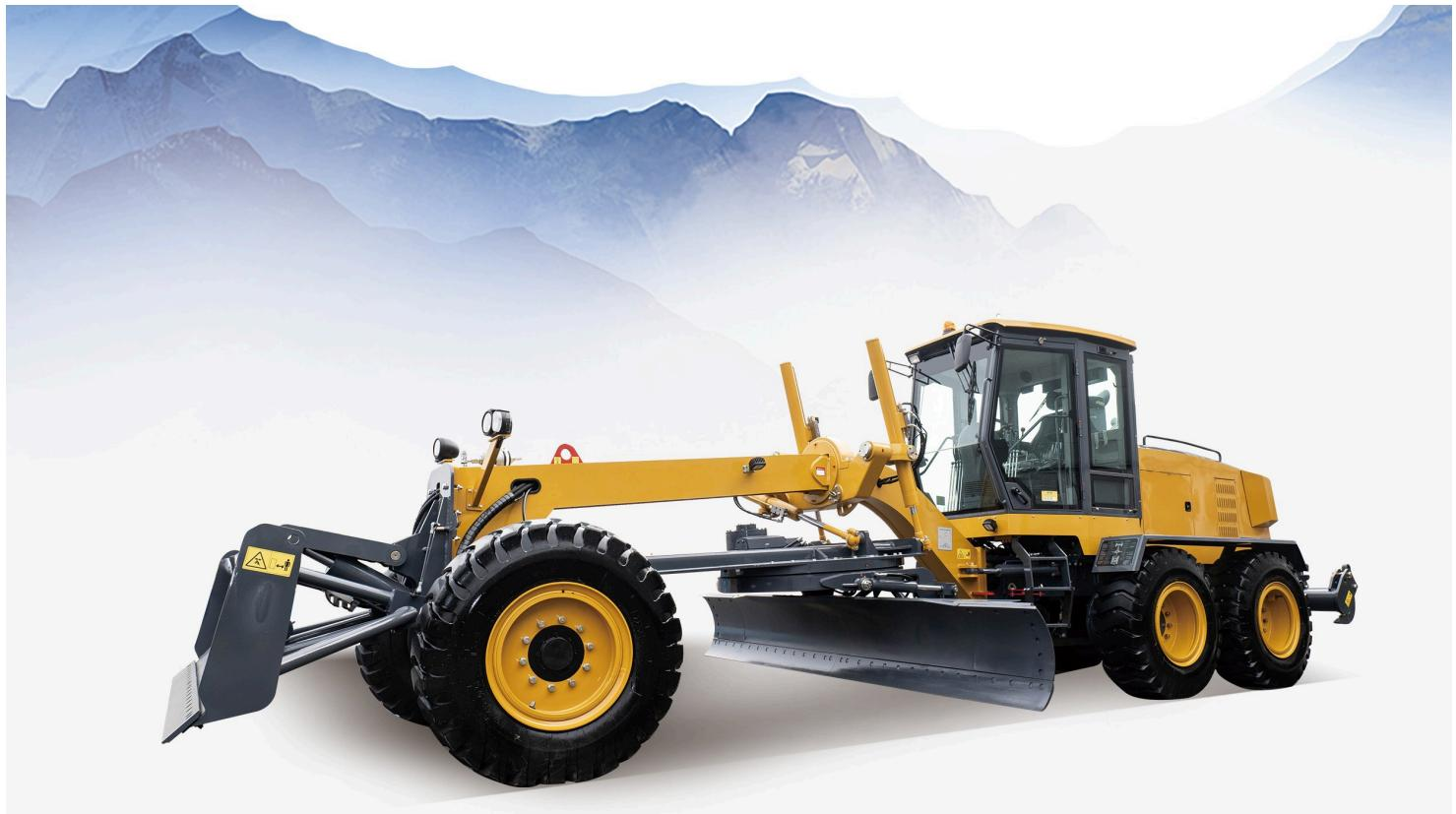
Полноприводный автогрейдер BEL-DOZER BG215AWD способен эффективно и быстро выполнять целый спектр земляных, строительных и транспортировочных задач. Спецтехника широко востребована при планировке площадей и откосов, послойном выравнивании грунта и других поверхностей. Автогрейдер незаменим при возведении железнодорожных, ирригационных и мелиоративных сооружений.
