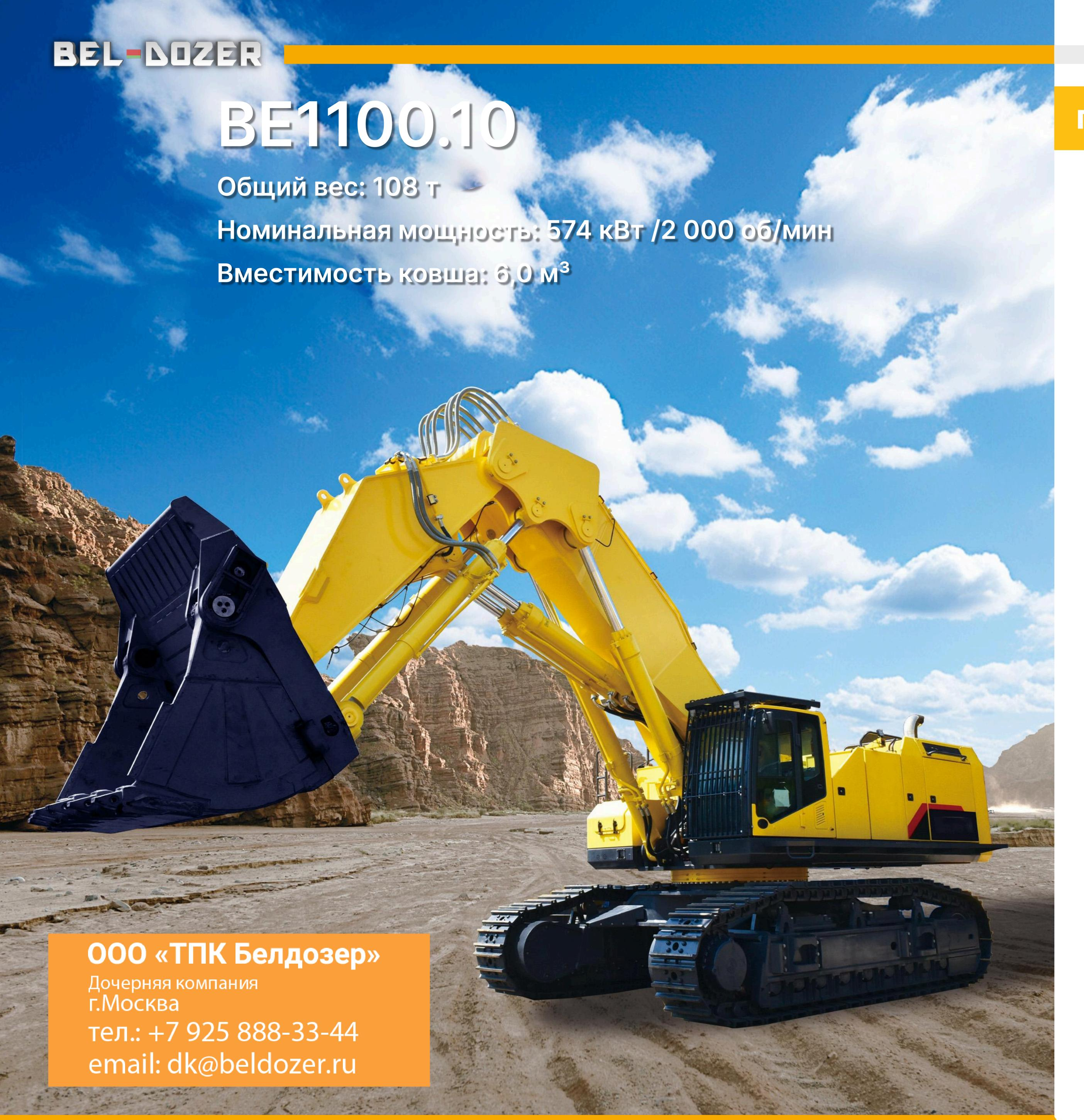
Оснащён высокомощным двигателем BEania DC16 мощностью 574 кВт при 2000 об/мин, что обеспечивает выдающуюся производительность и заслуживает доверия клиентов. Уникальный ЕСО-режим и гидравлическая система с положительным потоком гарантируют превосходную топливную экономичность.
